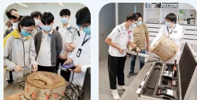
透過聲納探測儀探測樹幹內部情況
